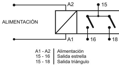
Temporizador arranque estrella - triángulo
